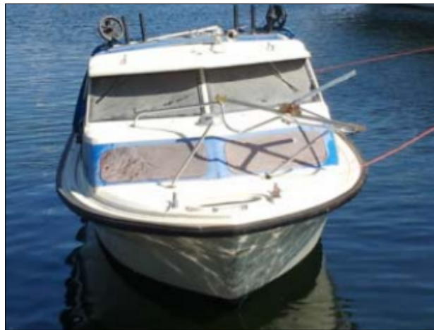
Figur 2.1: Mona III efter bärgning och tätning för test av flytförmåga (Transportstyrelsen, 2011).
