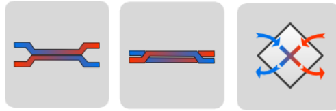
Figur 19 Utformning av symbol för värmväxlare.
