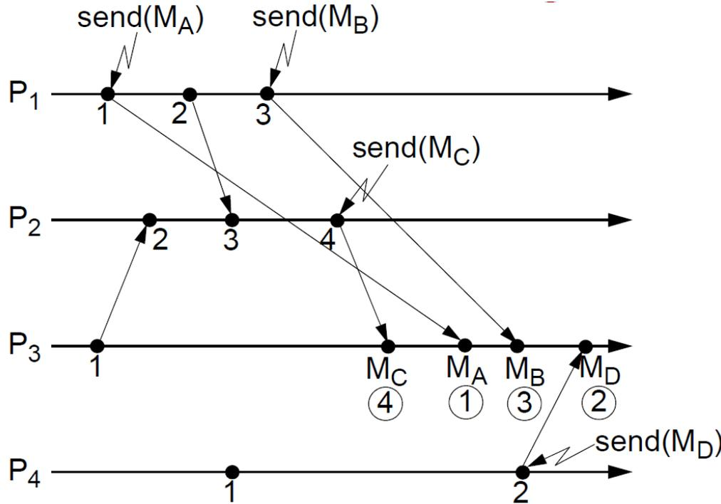
send(M<sub>A</sub>) → send(M<sub>C</sub>), send(M<sub>A</sub>) → send(M<sub>B</sub>)
