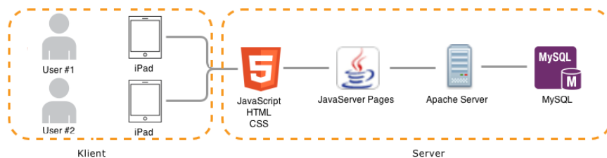
Figur 4.3: Översiktsbild på komponenter nödvändiga för körning av systemet.
