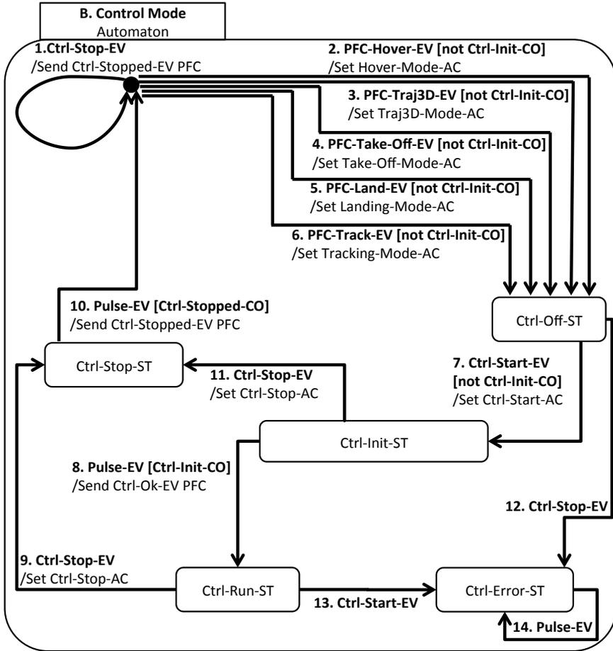
Figure 3.7: The *Control Mode* automaton.
